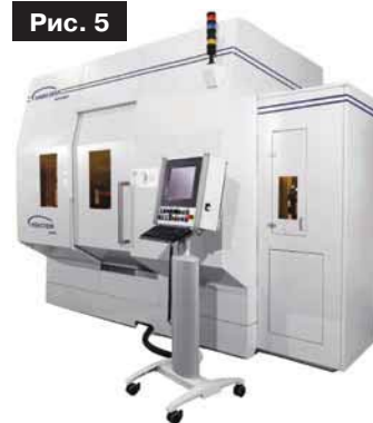
Многокоординатный электроэрозионный прошивочный станок HSD6-GT
