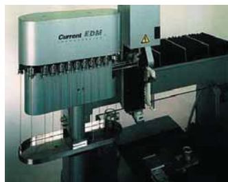
Устройство автоматической смены ЭИ
